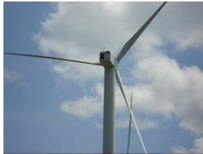
Figura 4.- Aerogenerador 3 palas eje horizontal con torre tubular.
