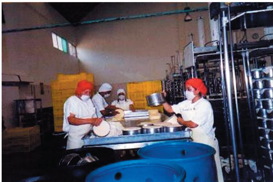
En la fotografía pueden apreciarse a la derecha, las prensas hidroneumáticas y a la izquierda, los empleados sacando el queso manchego de los moldes para salar las piezas.
