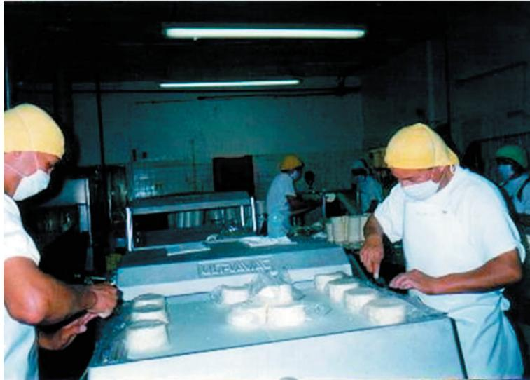
En esta fotografía se observa el proceso de empaclado de queso panela canasto en presentación de 400 grs. Se puede apreciar la plancha de la empacadora que encoge el plástico en el que previamente fue colocado cada queso.
