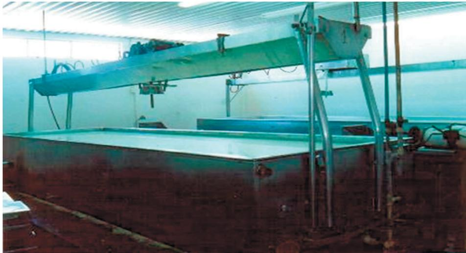
En seguida se puede apreciar la imagen de una típica tina de acero inoxidable para elaborar queso, se puede ver un larguero con un motor en la parte media superior, este es la guía y sostén del agitador.
