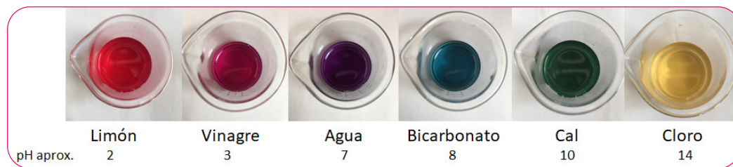
Figura 4. Coloración de las antocianinas de col morada en soluciones con diferente valor de pH.
