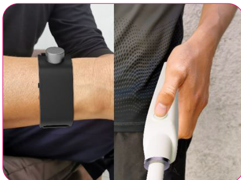
Figura 3. A la izquierda se observa la pulsera con sensor; a la derecha, el mango de bastón. Elaboración propia.
